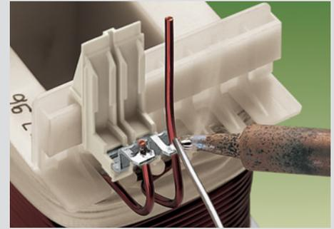
Adapter mit Löt-Anschluss für größere Querschnitte oder Anschluss mehrerer Spulendrähte bei Mittelanzapfung
